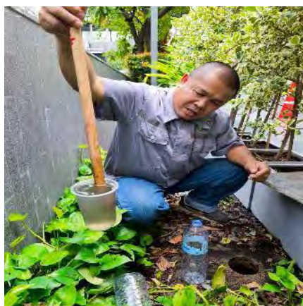
รูปที่ 3.5.2-1 การเก็บตัวอย่างคุณภาพน้ำทิ้งบริเวณบ่อบำบัดน้ำสุดท้ายในส่วนโรงแรม
