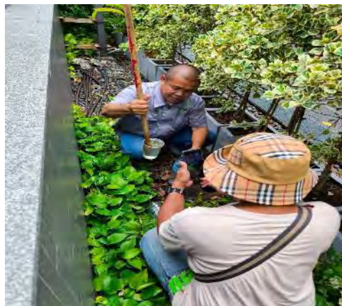
รูปที่ 3.5.2-1 การเก็บตัวอย่างคุณภาพน้ำทิ้งบริเวณบ่อบำบัดน้ำสุดท้ายในส่วนโรงแรม
