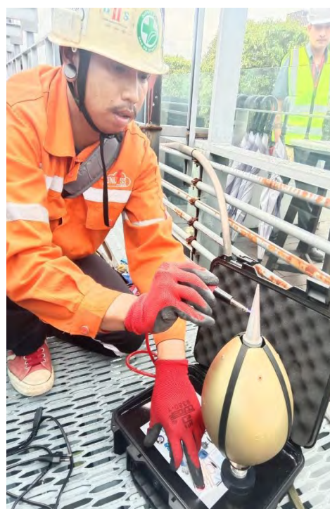
ภาพที่ 9-10-11-12 : ภาพแสดงการทดสอบหัวล่อฟ้า ด้วยเครื่องมือทดสอบ LPI TESTKIT
