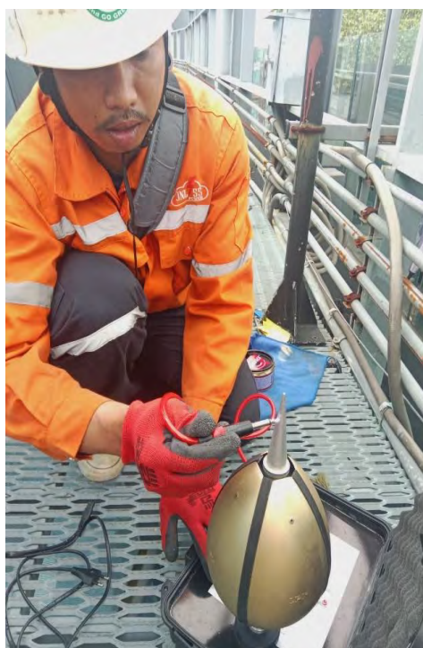
ภาพที่ 9-10-11-12 : ภาพแสดงการทดสอบหัวล่อฟ้า ด้วยเครื่องมือทดสอบ LPI TESTKIT
